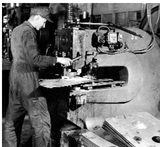
Arbeit an einer Exzenter-Stanz- maschine, um 1940
